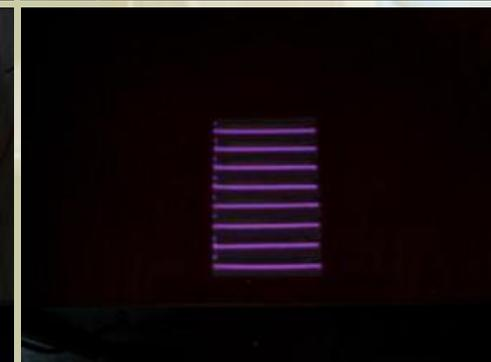
Polyphasiger Plasma-Aktuator erzeugt bei 2.66 kV rms mit 11 kHz bereits genug Ionenwind, um eine kleine Flamme ganz auszublasen (siehe [Video](#)).
