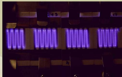
Erzeugung eines großflächigen Mikrostrukturelektrodenplasmas aus mehreren Mikrostrukturelektroden (Plasmafläche  $20 \times 120 \text{ m}^2$ )
